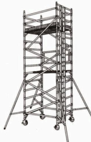
**★★警告！：永远都不能在没有护栏的平台上工作或者搭建/拆除塔架；每次从开窗踏板爬上塔架后都要马上关好窗板。**
